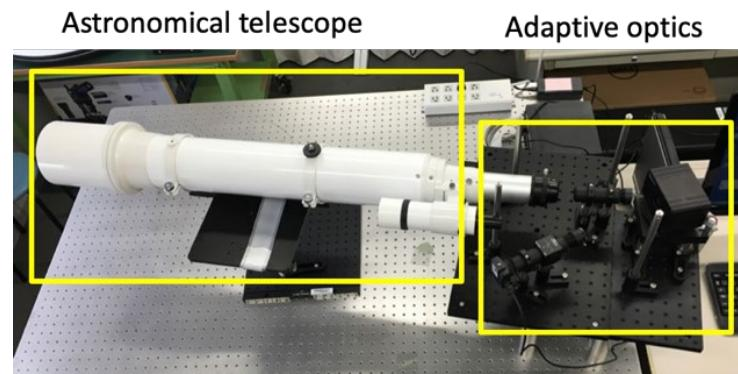
図2 補償光学系実験装置
