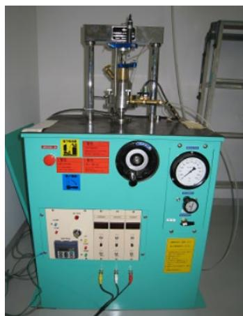
定ひずみ圧密試験装置
