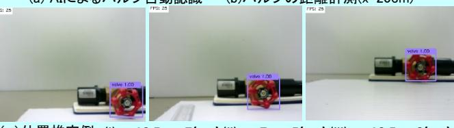
(c) 位置推定例 (i)  $y=-10.5, z=-7(\text{cm})$  (ii)  $y=-7, z=-5(\text{cm})$  (iii)  $y=-10.5, z=0(\text{cm})$
