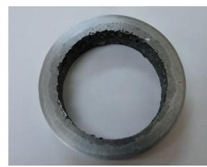
図3 遠心铸造法によって得られた傾斜組織 (Al-AlN)
