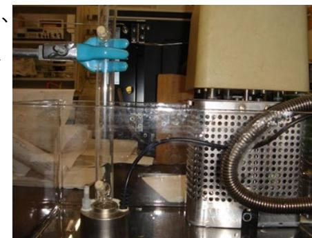
図1 2.4 MHz超音波発生装置
