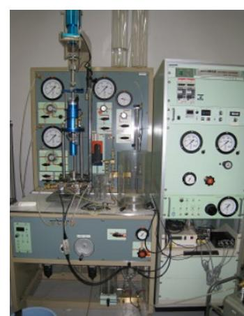
動的三軸圧縮試験装置
