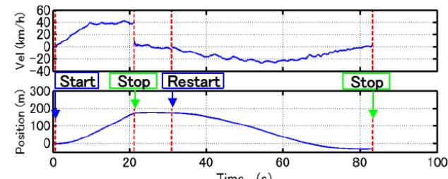
図3 昇降トライアル（200 m）時の速度と位置の解析結果
