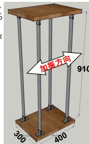
図1 鉄板4柱模型
