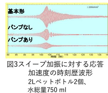
図3スイープ加振に対する応答
