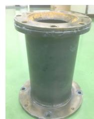
図2 遠心铸造用円筒金型
