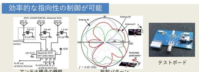
図2 ビーム切り替えアンテナの構造と測定結果
