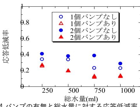
図4 バンプの有無と総水量に対する応答低減率
