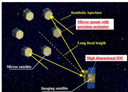
図1 FFSATの概念図(東京大学と共同研究)
