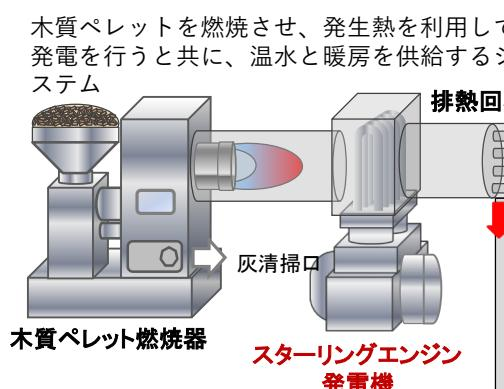
図1 木質ペレット燃焼発電給湯
