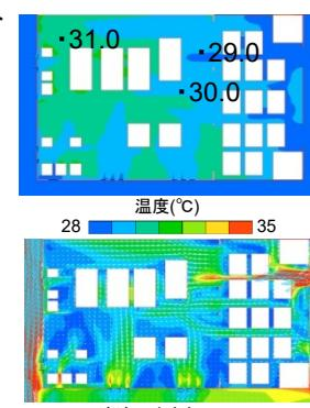
図4 平面温度分布（上図）及び平面流速分布（下図）
