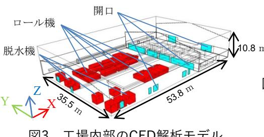
図3 工場内部のCFD解析モデル
