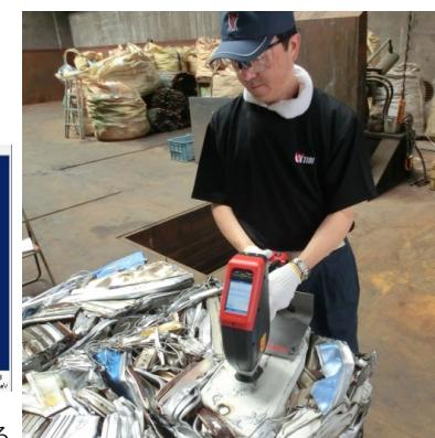
可搬型蛍光X線分析装置による現場分析（塗料剥離後に測定）
