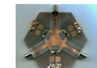
図4 人工ジャイロ磁性によるマイクロ波サーキュレータ
