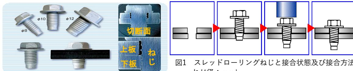
図1 スレッドドローリングねじと接合状態及び接合方法
