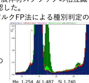
図1 アルミの主ピークの近傍にあるSiおよびMgのXRFスペクトル
