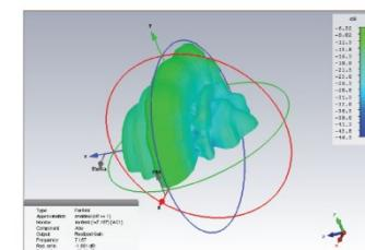
図3 アンテナの放射パターンのシミュレーション結果
