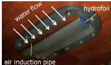
図2 空気導入管を有する水中翼
