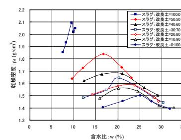
図-1 締固め曲線
