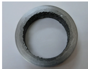
図3 遠心鑄造法によって得られた傾斜組織 (Al-AIN)
