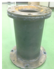
図2 遠心鑄造用円筒金型
