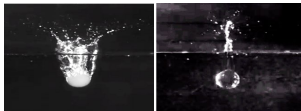
図1 膨潤度100の寒天ゲル球（左）とアクリル樹脂球（右）によるスプラッシュの違い
