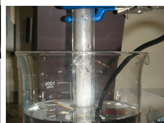
図2 超音波霧化実験 反応溶液は底面の振動子と直接接触
