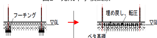
図3 床スラブで建物の荷重を支える
