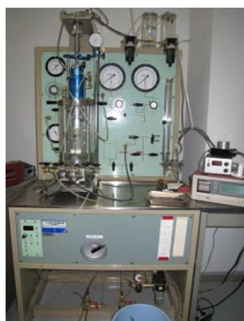
三軸圧縮試験装置
