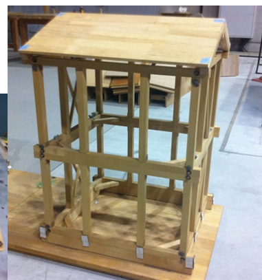
図1 木造軸組み模型と小屋組内に設置したペットボトル
