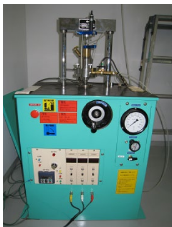
定ひずみ圧密試験装置
