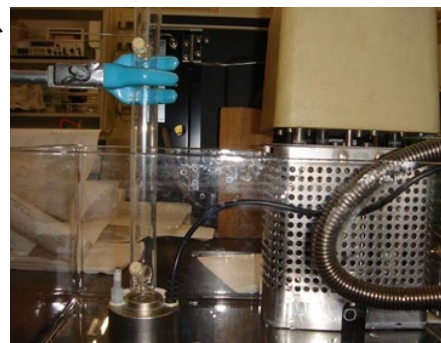
図1 2.4 MHz超音波発生装置 霧化能力：250 mL \pm 50 mL/h
