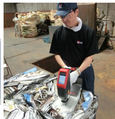
可搬型蛍光X線分析装置による現場分析（塗装剥離後に測定）
