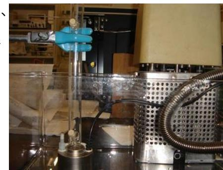
図1 2.4 MHz超音波発生装置
