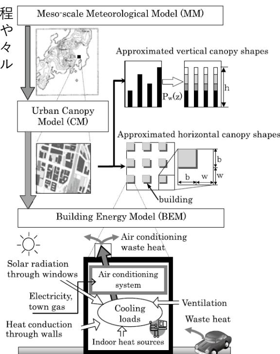
図2 結合モデルシステムの構成
