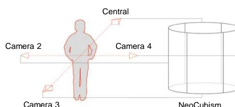
図2 カメラ配置と3Dモデルの関係
