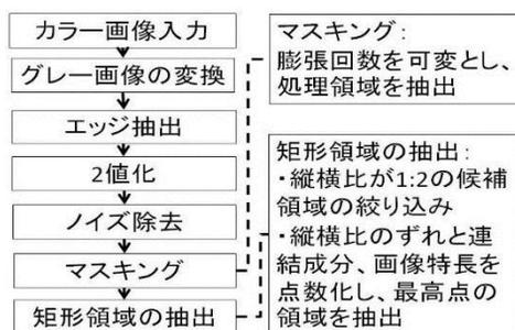
図2 ナンバープレート抽出の処理手順
