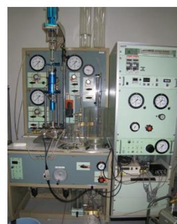
動的三軸圧縮試験装置
