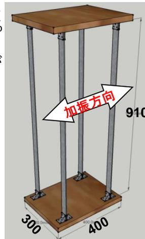
図1 鉄板4柱模型
