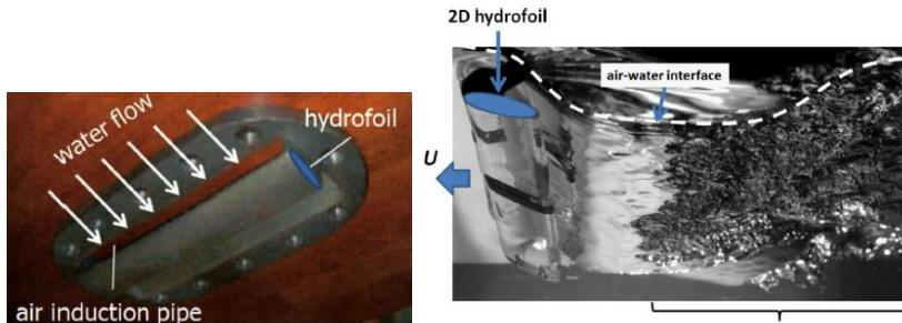
図2 空気導入管を有する水中翼
