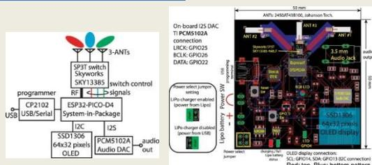
図3 Web RadioのPCBレイアウト
