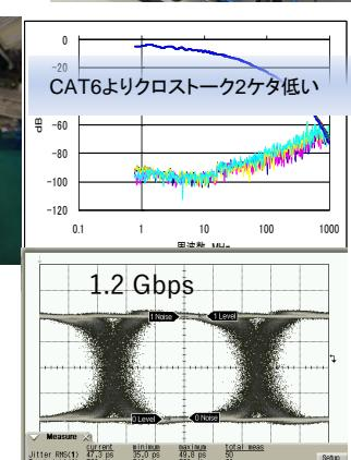
図2 エバネッセント波測定例（ケーブル68 m測定例）
