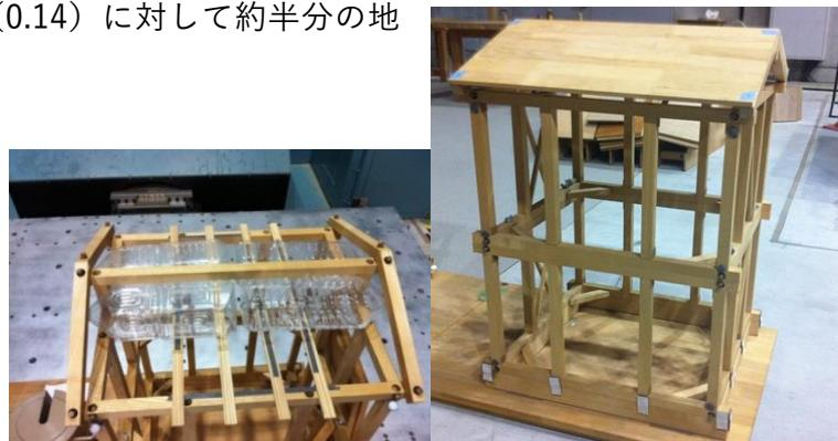
図1 木造軸組み模型と小屋組内に設置したペットボトル
