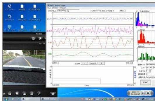
図1 車載生体情報計測システム
