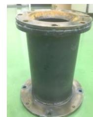
図2 遠心铸造用円筒金型
