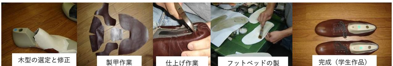
図2 靴製作の流れ 足の各部を計測し、加工した木型から型紙を作り、その型紙に基づいて革を裁断する（製造甲作業）。木型にそって革を3次元に作り上げ（つり込み作業）、別に製作した靴底部分と合体させる。中敷きは、足の底部の計測から調整しながら製作する（フットベットの製作）。中敷きを靴に入れて完成させる。
