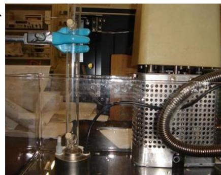
図1 2.4 MHz超音波発生装置
