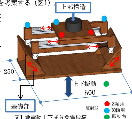
図1 地震動上下成分免震機構
