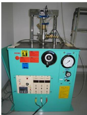
定ひずみ圧密試験装置
