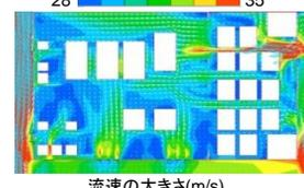
図4 平面温度分布（上図）及び平面流速分布（下図）
