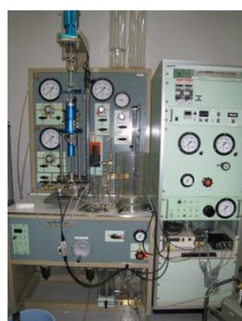
動的三軸圧縮試験装置
