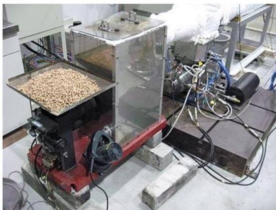
図1 木質ペレット燃焼発電給湯システム
