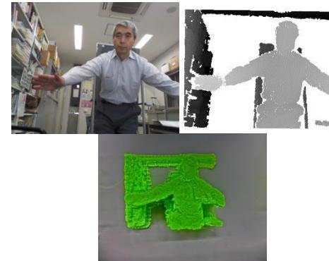
注1)：使用した複合センサは、赤外線を使用する距離センサとRGBカメラを搭載し、奥行きを表すDepth画像が得られる
