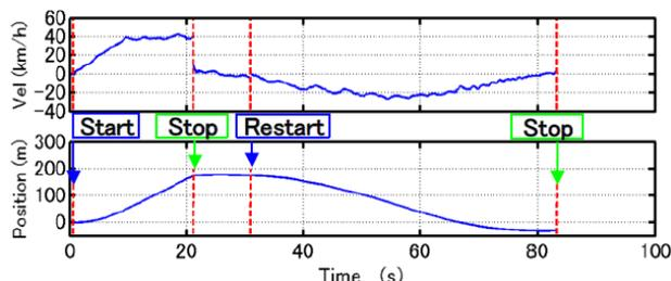
図3 昇降トライアル（200 m）時の速度と位置の解析結果
