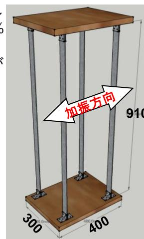
図1 鉄板4柱模型
