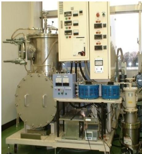
図1 遠心鑄造装置
