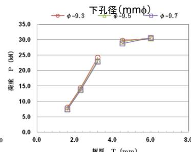
図4 せん断強度：板厚と最大荷重
