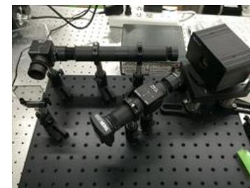
図2 補償光学系実験装置
