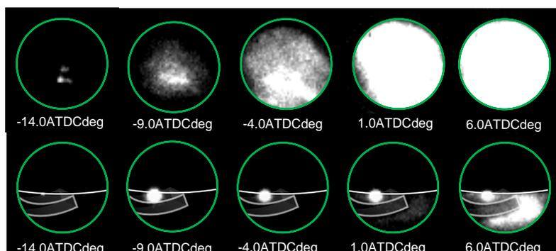
図3 レーザーブレークダウン着火（上）と火花点火の比較
