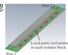
図2 電磁界モデル（上）と放射ビーム走査漏洩波アンテナ（下）
