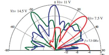
図4 放射パターンの測定結果
