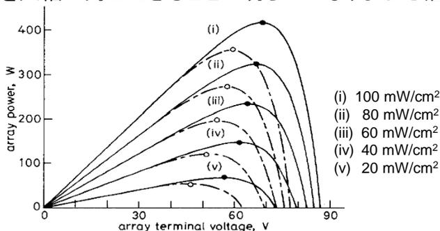
図1 電流と電圧の関係(P-V曲線)
