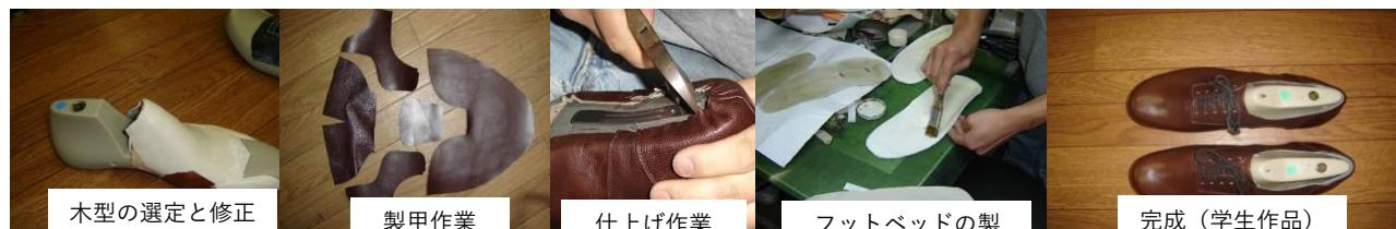
図2 靴製作の流れ 足の各部を計測し、加工した木型から型紙を作り、その型紙に基づいて革を裁断する（製造甲作業）。木型にそって革を3次元に作り上げ（つり込み作業）、別に製作した靴底部分と合体させる。中敷きは、足の底部の計測から調整しながら製作する（フットベッドの製作）。中敷きを靴に入れて完成させる。
