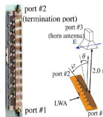
図2 漏洩波アンテナ試作品（左）
