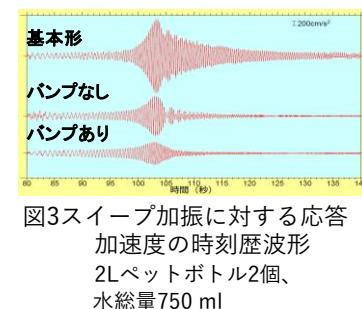
図3スイープ加振に対する応答
