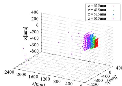
図2 赤外線距離センサでの壁面測定
