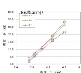
図3 引張強度：板厚と最大荷重
