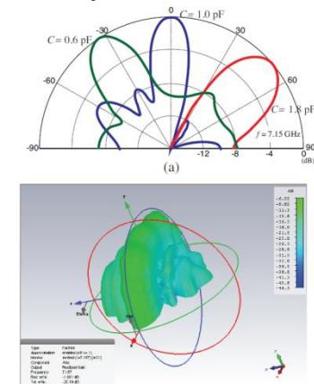
図3 アンテナの放射パターンのシミュレーション結果
