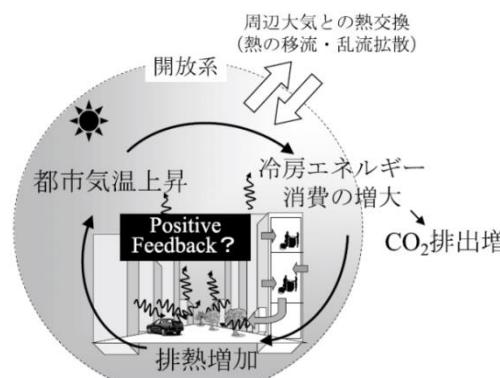
図1 都市高温化と冷房エネルギー需要増のフィードバックプロセス
