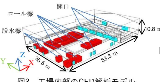
図3 工場内部のCFD解析モデル
