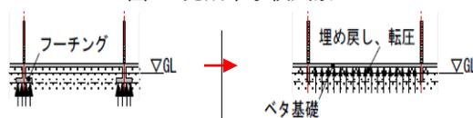
図3 床スラブで建物の荷重を支える
