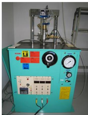
定ひずみ圧密試験装置
