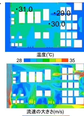
図4 平面温度分布（上図）及び
