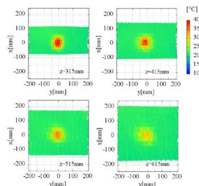
図3 推定壁面に基づいた温度分布図
