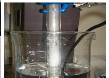
図2 超音波霧化実験 反応溶液は底面の振動子と直接接触
