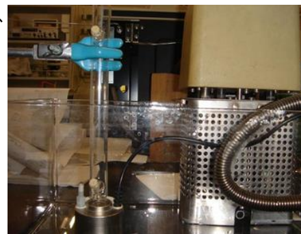
図1 2.4 MHz超音波発生装置 霧化能力: 250 mL ± 50 mL/h
