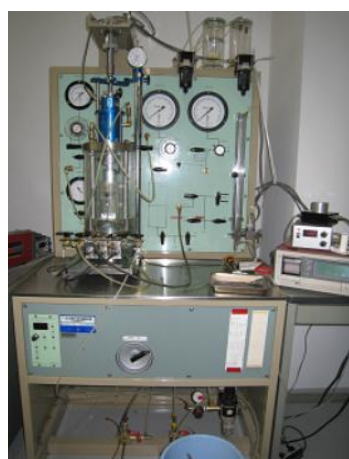
三軸圧縮試験装置
