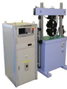
図3 油圧サーボ 疲労試験機
