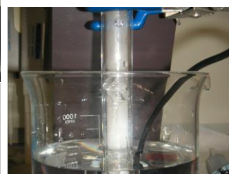
図2 超音波霧化実験 反応溶液は底面の振動子と直接接触
