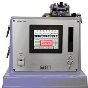
図1 平面曲げ・ねじり 疲労試験機
