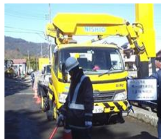
写真2 橋梁点検車による調査作業 橋梁点検車（左）と橋脚調査作業（右）
