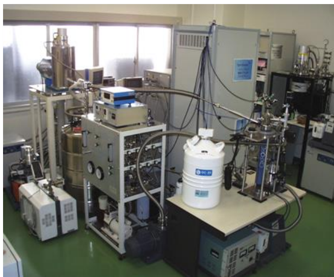
図1 液体ヘリウム再凝縮式・連続流型冷装置と極低温電気物性測定装置
