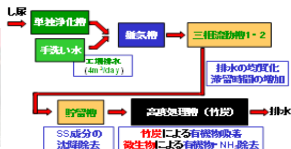
図3. 金属加工工場の排水処理フロー
