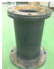
図2 遠心鑄造用円筒金型
