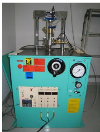
定ひずみ圧密試験装置
