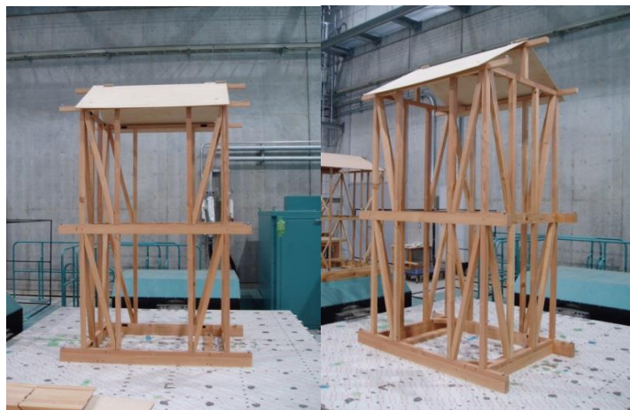
2層軸組模型を3次元振動台に設置した様子
