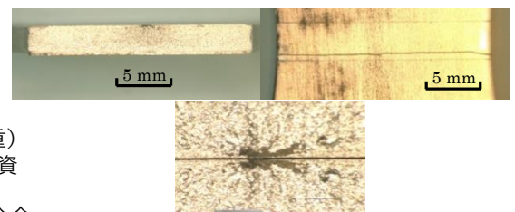
図2 破断面と表面き裂及びき裂の起点部 \sigma_a = 107 \text{ MPa} 、 N_f = 5.7 \times 10^4 下図：破産面を重ね合わせて拡大
