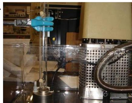
図1 2.4 MHz超音波発生装置
