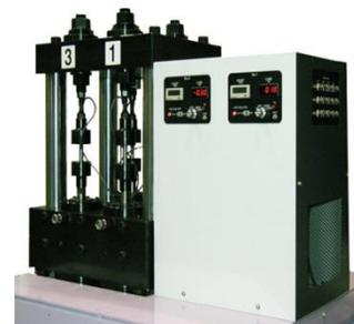
図4 多連式軸荷重
