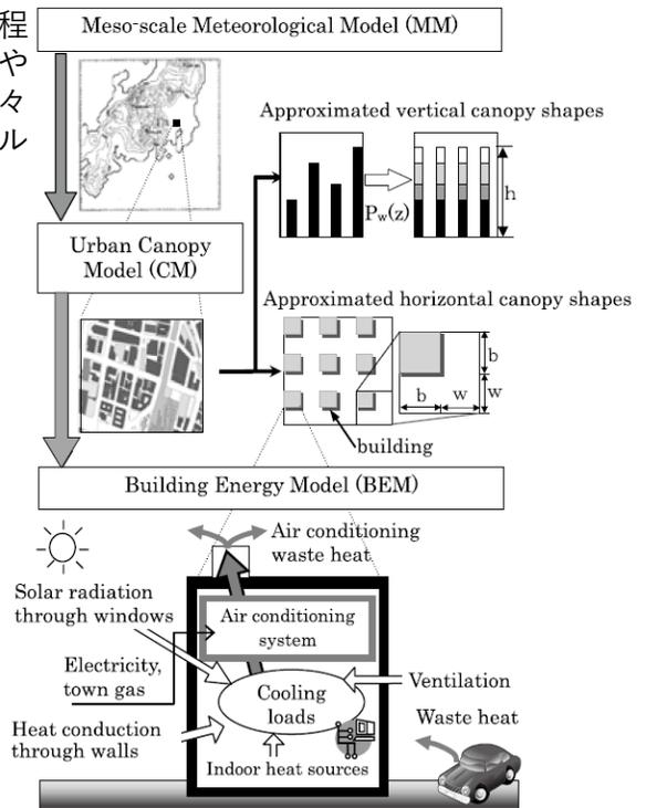
図2 結合モデルシステムの構成
