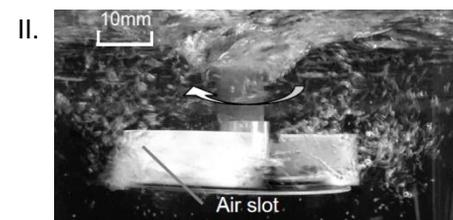
図1 回転翼型曝気実験装置模式図と回転水中翼からの放出気泡
