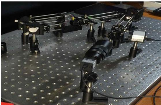
写真: 補償光学実験装置
