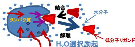
図1 WaterLOGSY法 (水分子を選択的に励起)
