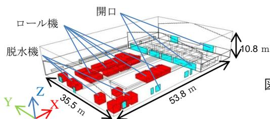
図3 工場内部のCFD解析モデル
