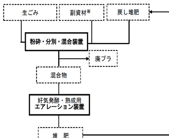
図1 堆肥化システムの処理フロー
