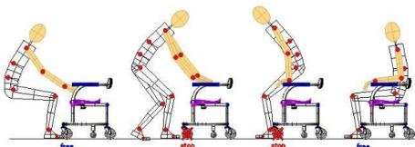
キャスターの方向軸と車輪の回転の動きに対して同時に制動をかける
