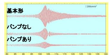
図3 スイープ加振に対する応答
