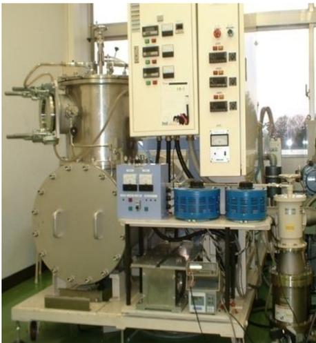
図1 遠心鑄造装置
