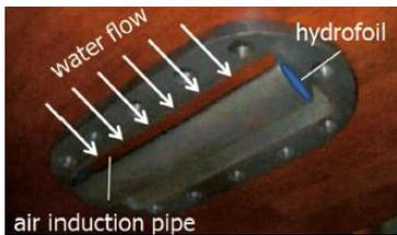
図2 空気導入管を有する水中翼
