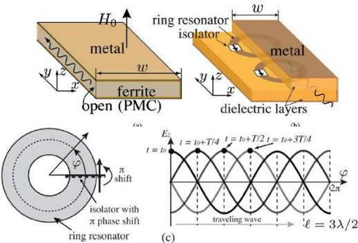
図1 ビーム走査漏洩波アンテナ
