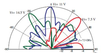
図4 放射パターンの測定結果
