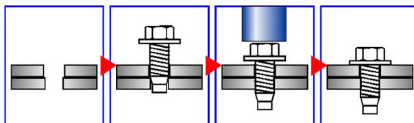
図1 スレッドローリングねじと接合状態及び接合方法
