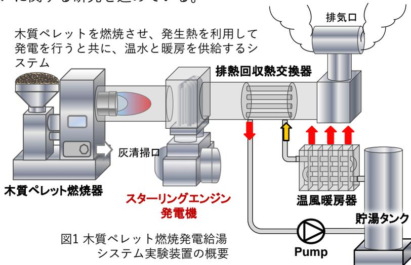
図1 木質ペレット燃焼発電給湯システム実験装置の概要
