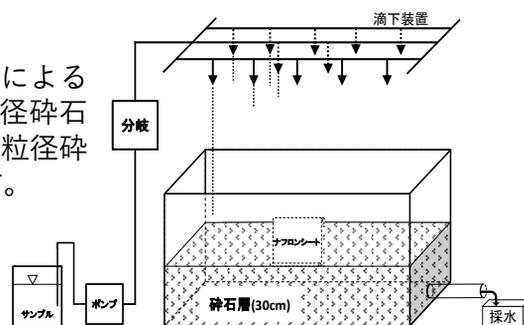
図1 大粒径碎石層における浸出水流出模擬装置
