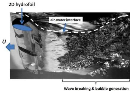
図3 水中翼による気泡発生状況
