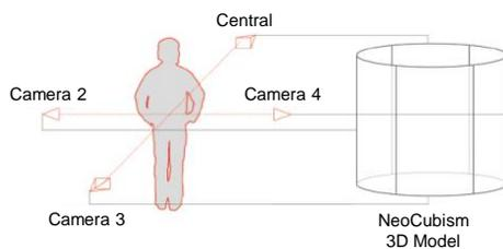
図2 カメラ配置と3Dモデルの関係
