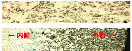
図4 傾斜組織の光学顕微鏡写真
