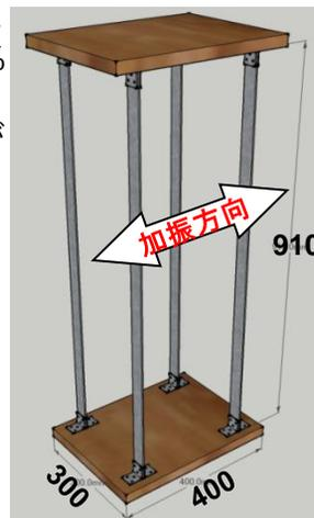
図1 鉄板4柱模型
