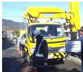
写真2 橋梁点検車による調査作業
