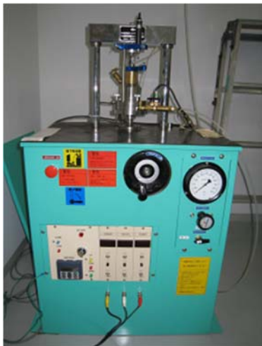
定ひずみ圧密試験装置
