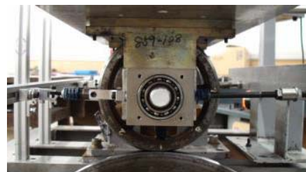
図2 模型輪軸(1/5スケール)と軸箱前後支持剛性減衰付加コイルばねとオイルダンパー
