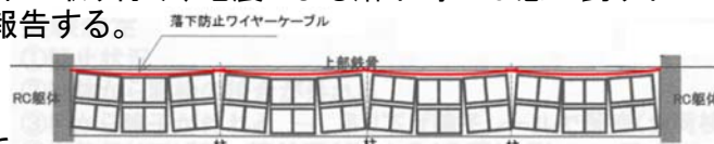
図1 窓枠落下防止装置の概念図
