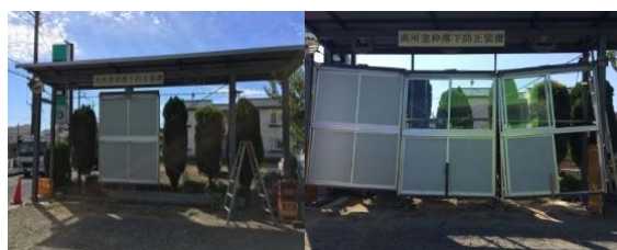
図3 窓枠1及び3ピース落下実験の様子
