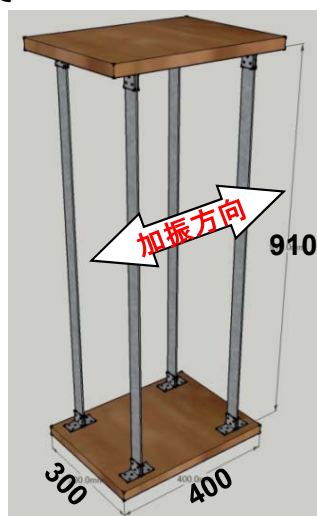
図1 鉄板4柱模型 鉄板四柱模型の 頂部に水槽設置
