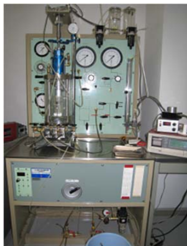
三軸圧縮試験装置
