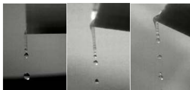
図3 容器傾斜角 左:0°、中:10°、右30°
